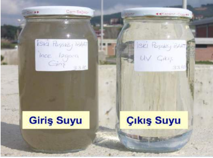
Şekil 14.35 İSKİ Paşaköy ileri biyolojik atıksu arıtma tesisi girişi ve geri kazanım dezenfeksiyon ünitesi çıkış suyuna ait fotoğraflar (MEM-TEK Bülteni, 2015)
