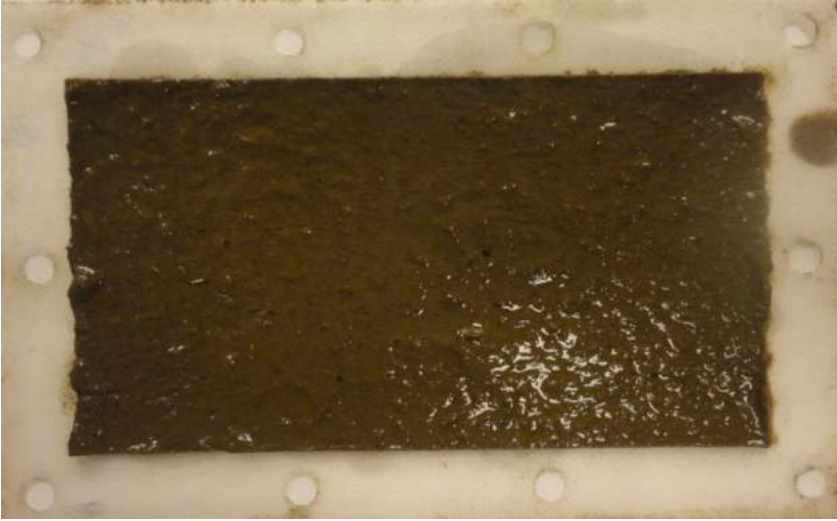
Şekil 11.4 Destek tabakası üzerinde oluşan DM tabakası (Ersahin, 2015)
