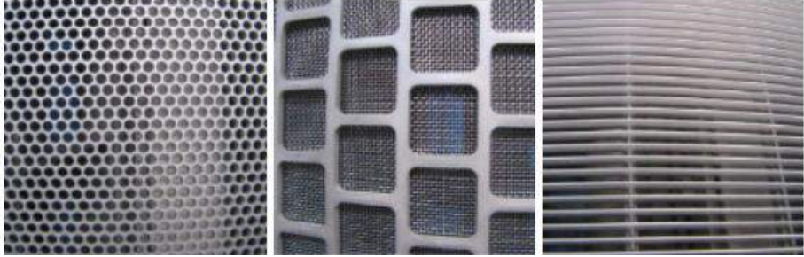
Şekil 9.14 MBR sistemlerinde kullanılan ızgara/eleklerin görünümü (Frechen, 2010)
